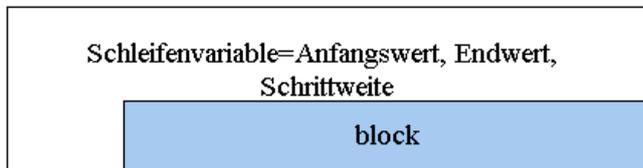
"block" wird solange ausgeführt, bis Schleifenvariable den Endwert überschritten / erreicht (entspr. Sprachfestlegung) hat
