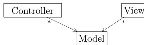
Zwischen Model und View wird häufig ein Observer-Pattern eingesetzt. Oft sind Controller und View in einer GUI integriert, oder der Controller lebt von Ereignissen die ein View sendet. Das ergibt daher folgende Struktur:
