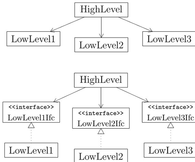
Für die drei low-level Klassen haben sich die Pfeilrichtungen (Abhängigkeiten) umgekehrt. Die Entwurfsmuster Abstract Factory und Factory Method lösen dieses Problem, indem jeweils abstrakte Klassen oder Schnittstellen für die Kopplung zwischen high- und low-level Klassen verwendet werden.
