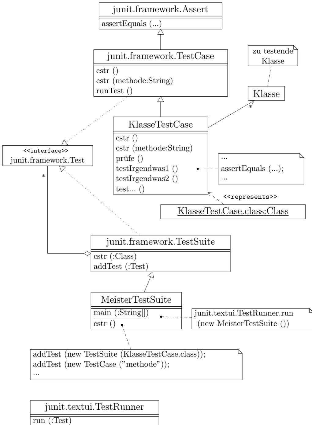
Das Klassendiagramm zeigt unter anderem ein Composite-Pattern, bei dem ein `Test` entweder ein `TestCase` (Blatt) oder eine `TestSuite` (Composite) sein kann, die mehrere Tests enthalten kann.
