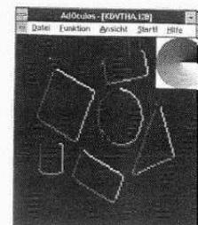
Abb. 6.12. Ergebnis der Verdünnung des Gradientenrichtungsbildes
