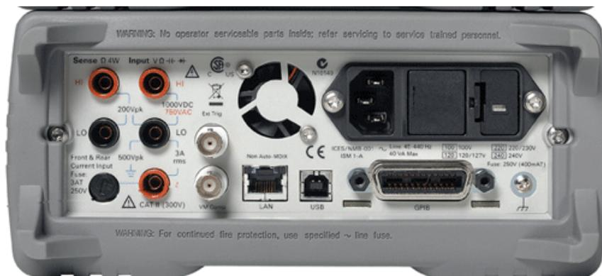
Bild 6: Rückseite des Multimeters "Agilent 34401A"
