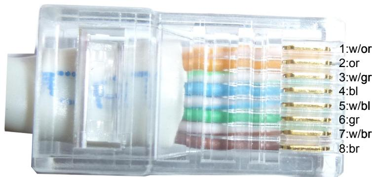
Abbildung 3: Steckerbelegung nach EIA/TIA 568B auf Kontaktseite gesehen
