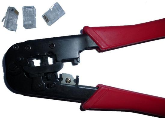
*Abbildung 4: Crimpzange und RJ-45 Stecker*
