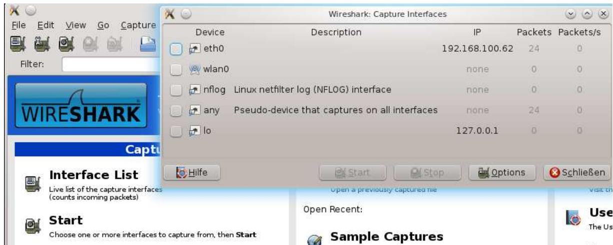
Mit den „Display Options“ „Update list of packets in real time“ und „Automatic scrolling in live capture“ können die gelesenen Pakete direkt angezeigt werden, Abbildung 13 zeigt beispielhaft die Einstellung an einem Kontroll-PC.. Das automatische „scrollen“ erlaubt den Blick auf die aktuell eingelesenen Pakete. Zur genaueren Auswertung sollte dann die Aufzeichnung mit der Auswahl „Capture“ und „Stopp“ angehalten werden.
